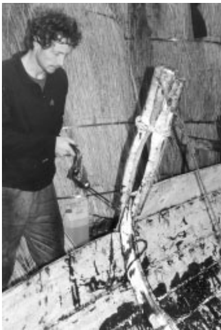
Mischa Naimark från Ryssland bygger en s.k. "sydd" båt på Fotevikens Museum efter uråldrig teknik som fortfarande praktiserades i vissa delar av nordvästra Ryssland på 1920-talet.
