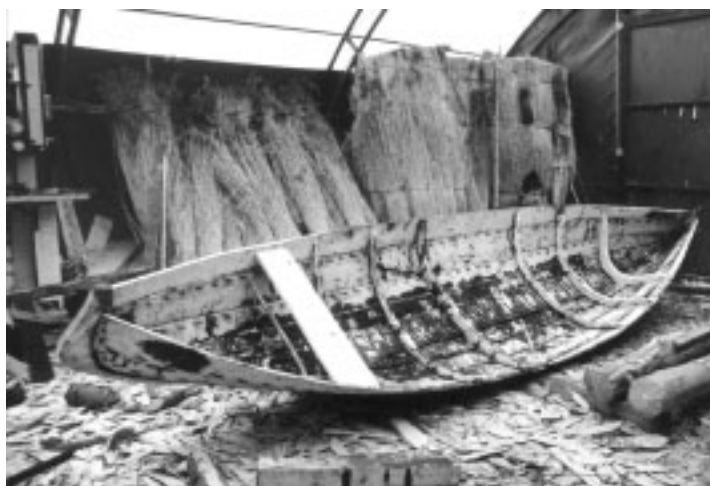
Mischa Naimark från Ryssland bygger en s.k. "sydd" båt på Fotevikens Museum efter uråldrig teknik som fortfarande praktiserades i vissa delar av nordvästra Ryssland på 1920-talet.
